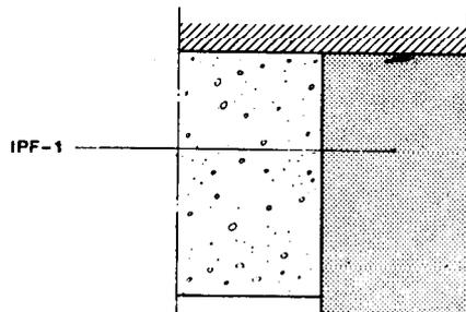
IPF - 1 Mortero aislante. Se aplicará en toda la superficie de la viga formando un espesor E en cm determinado en Cálculo.
