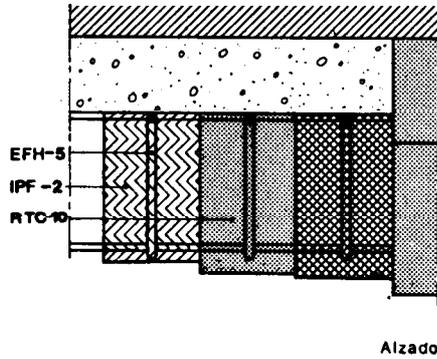
EFH - 5 Cercos formados por redondos de acero AE-42 de diámetro 6 mm, dispuestos cada 50 cm, soldados por puntos a la viga.
