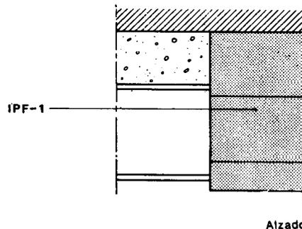
IPF - 1 Mortero aislante. Se aplicará sobre una capa de adhesivo dada al perfil hasta alcanzar un espesor E en cm determinado en Cálculo.
