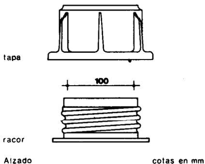
Permitirá la conexión de manguera. De latón con rosca de filete redondo, y tapa roscada del mismo material. Estará preparado para ser embreado a tubo.
