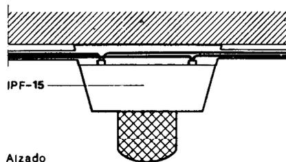
IPF-15 Detector de humos. Para su colocación se fijará el soporte del detector al techo y se conectará, a través de las bornas, con la línea de señalización de detectores.
