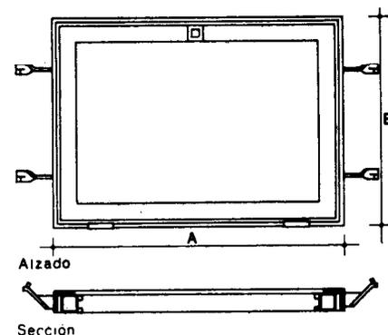
Compuesta por cerco de acero de perfil L 30-3 provisto de dos patillas de anclaje en cada lateral y hoja de tubo cuadrado soldado 25-1.
