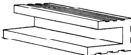
Pieza cerámica de forma conveniente para cubrir la semiala inferior de vigas de acero. Sin alabeos, roturas, deformaciones ni caliches.
