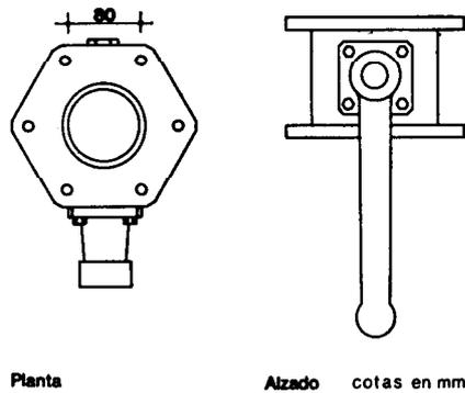
Permitirá el corte total del paso de agua, mediante palanca de accionamiento a 1/4 de vuelta.
