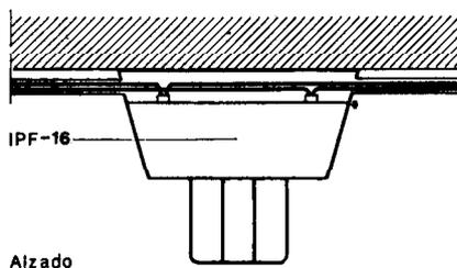
IPF-16 Detector de temperatura. Para su colocación se fijará el soporte del detector al techo, y se conectará a través de las bornas con la línea de señalización de detectores.
