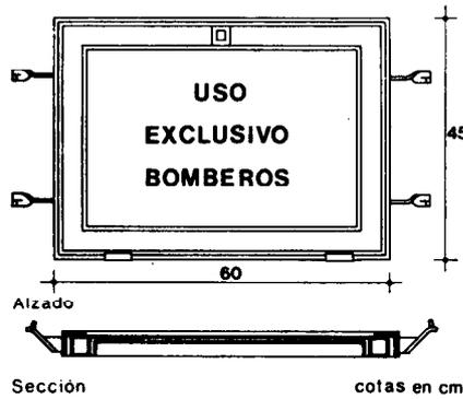
Compuesta por cerco de acero de perfil L 30-3 provisto de dos patillas de anclaje en cada lateral, hoja de tubo cuadrado soldado 25-1 y chapa de acero de 0,5 mm de espesor con inscripción indeleble en rojo "uso exclusivo bomberos" sobre fondo blanco.
