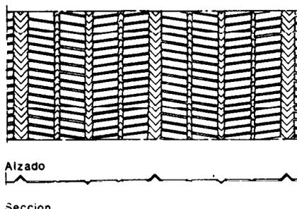
Chapa de acero galvanizado, desplegada o con perforaciones para favorecer el agarre del mortero que pueda aplicarse sobre ella. Su espesor no será menor de 0,3 mm.
