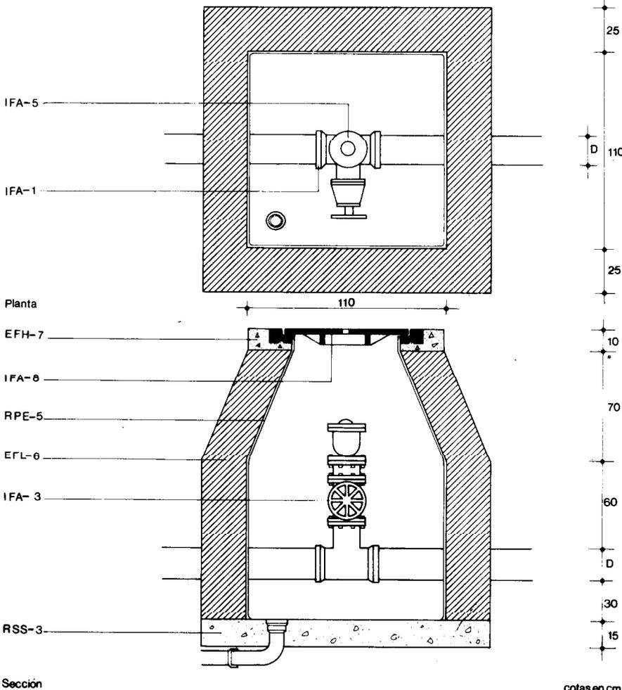
IFA - 1 Tubo y piezas especiales. Pieza en T conectada a la conducción con la derivación terminada en brida. Tubo de desagüe conectado a la red de alcantarillado, de diámetro 60 mm.
