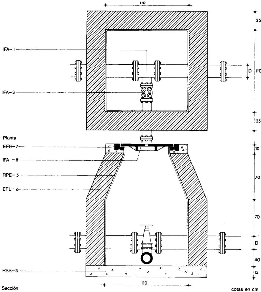
IFA - 1 Tubo y piezas especiales. Pieza en T conectada a la conducción, con la derivación terminada en brida, unida a un codo de 90° y éste a la llave de compuerta. El tubo de desagüe tendrá un diámetro de 80 mm cuando el de la conducción principal sea igual o menor de 200 mm y de 100 mm cuando sea mayor de 200 mm.
