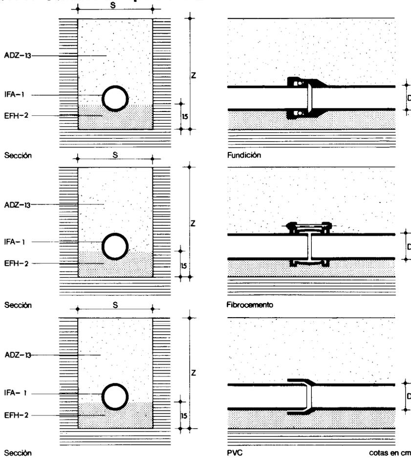
IFA - 1 Tubo y piezas especiales. Irá enterrado en una zanja de dimensiones S y Z, en cm, en función del diámetro D, en mm, del tubo.
