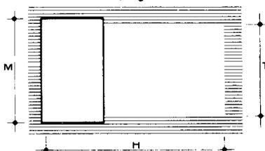
La Tabla 21 permite determinar, en función del diámetro  $D$ , en mm, de la conducción y del tipo de tubería, los diámetros  $R$  y  $V$ , en mm, de la válvula reductora y de la ventosa respectivamente, así como las dimensiones  $H$ ,  $T$  y  $M$ , en cm, de la arqueta y tapa para la válvula reductora.
