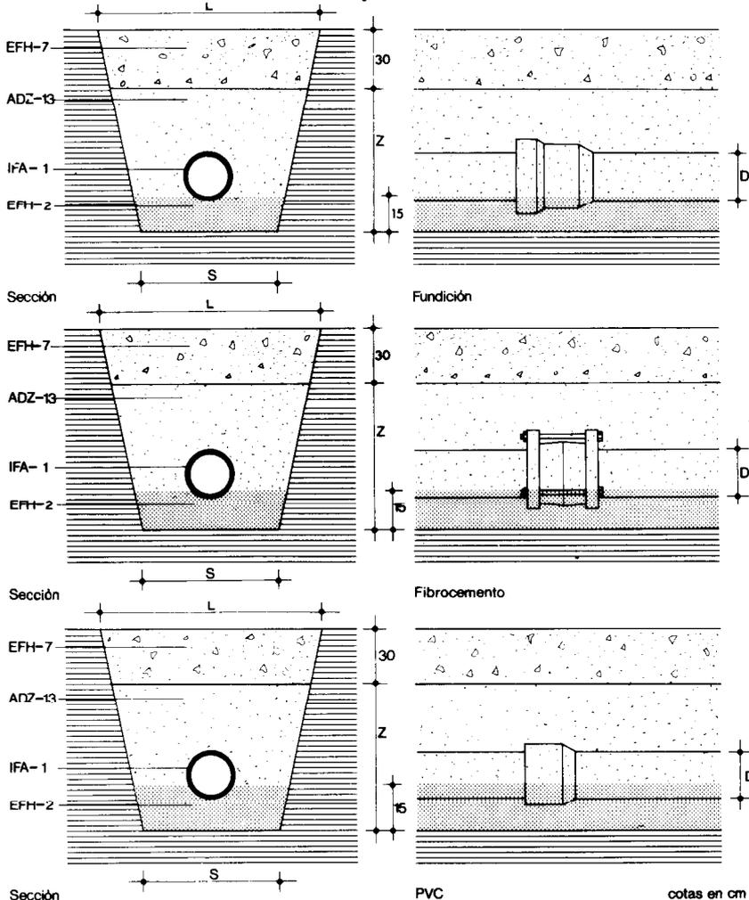
IFA - 1 Tubo y piezas especiales. Irá enterrado en una zanja de dimensiones S, L y Z, en cm, en función del diámetro D, en mm, del tubo.
