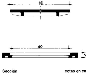
De fundición. Superficie exterior con dibujo de profundidad 4 mm, e interior con nervios de refuerzo.
