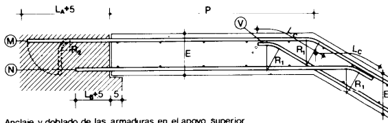
Anclaje y doblado de las armaduras en el apoyo superior
