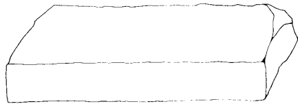
Mampuesto a sogá
