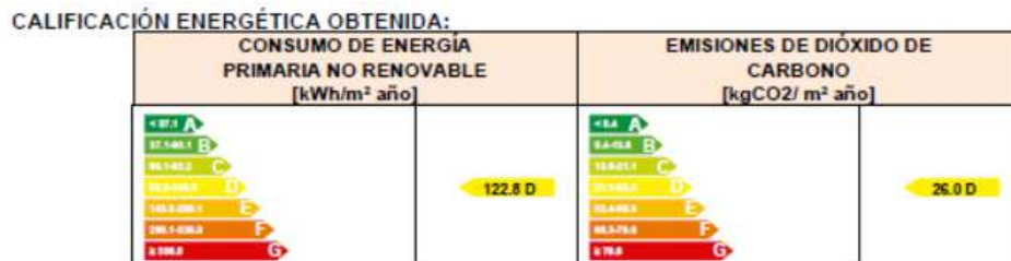
CONSUMO Y EMISIONES CON GENERACIÓN FOTOVOLTAICA
