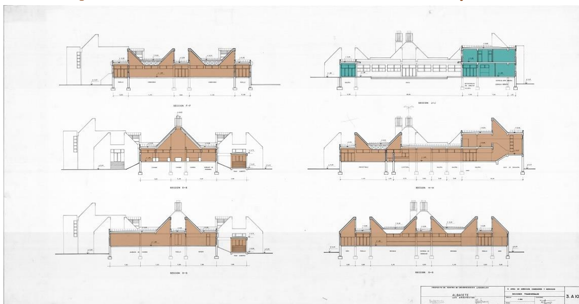
Figura 7. Secciones transversales del área de dirección, comedores y servicios
